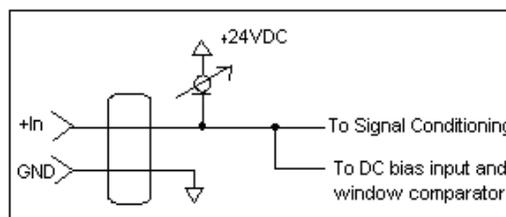
Figure 2 ICP<sup>®</sup> Sensor Excitation
