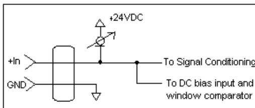
**Figure 2 ICP<sup>®</sup> Sensor Excitation**
